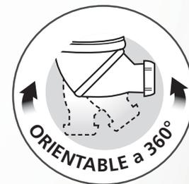
Una solución económica e ingeniosa. La válvula es orientable a 360°, se puede instalar con salida horizontal, vertical o en cualquier posición y la brida textil premontada garantiza una óptima estanqueidad.
