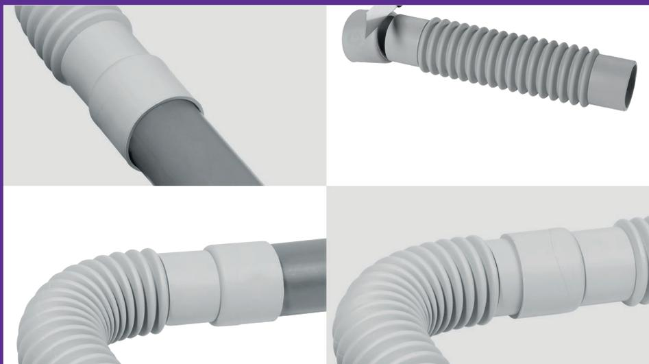
Manguito universal Magicoude de WIRQUIN que permite conectar un sifón y un tubo o 2 tuberías juntas. El cuerpo flexible permite compensar si los 2 elementos no están alineados. ¡Evita encolar muchos accesorios! Cada extremo puede ser hembra o macho, cortando el extremo necesario para que se ajuste a todas las configuraciones.
