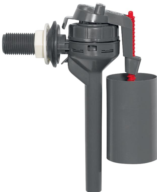
El TOPY de WIRQUIN es un grifo flotador de entrada lateral universal que se adapta a cualquier tipo de cisterna. Dispone de la tecnología de servo-válvula que permite un llenado rápido de la cisterna (un llenado completo en 42 segundos) y resistencia a los picos de presión. TOPY es compacto y el nivel del agua se puede ajustar gracias al tornillo. Su conexión es estándar y puede adaptarse a cisternas vistas y empotradas .
